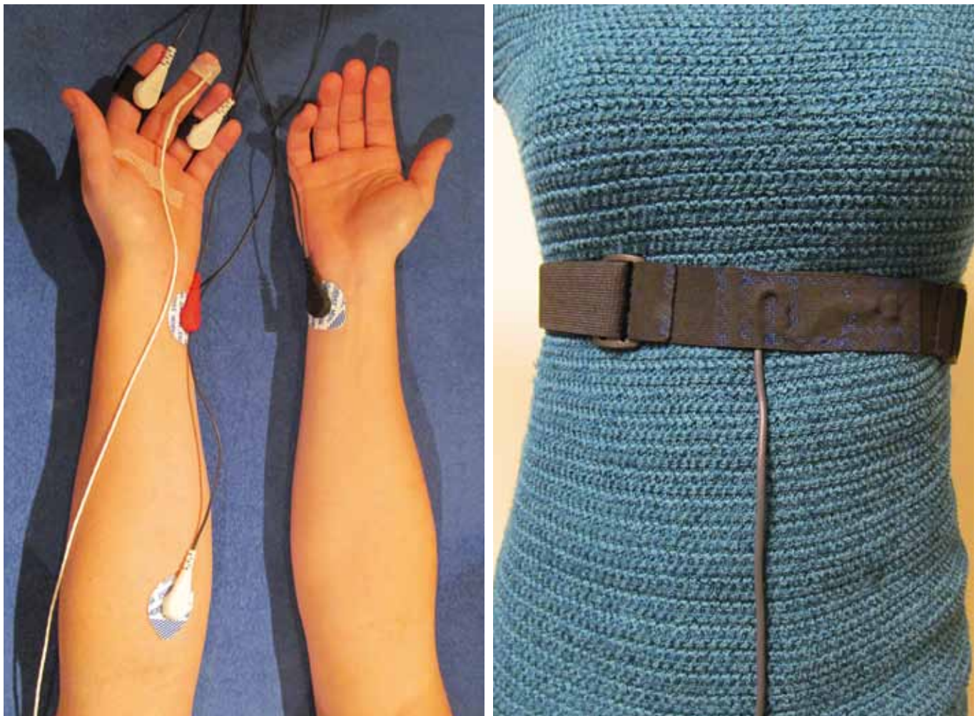
Abbildung 1: Bildliche Darstellung der Sensorpositionen am Körper des Probanden zur Erfassung der physiologischen Messgrößen.
